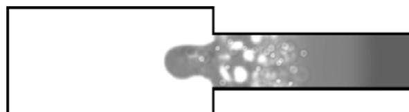
Рис.7 Вскипание пересжатой жидкости при истечении из канала в открытый объем.
