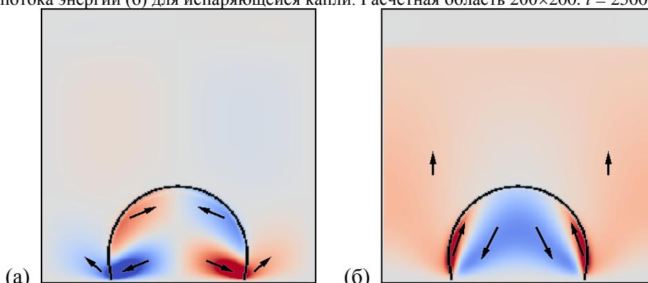
Рис. 2. Распределения горизонтального (а) и вертикального (б) потоков массы флюида. Расчетная область  $200 \times 200$ .  $t = 25000$ .
