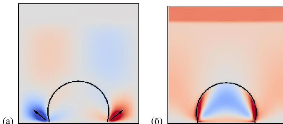
Рис. 1. Распределения горизонтальной скорости флюида (а) и вертикального потока энергии (б) для испаряющейся капли. Расчетная область  $200 \times 200$ .  $t = 25000$ .
