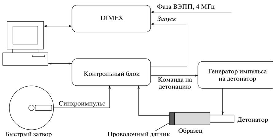
Рис. 5. Блок-схема экспериментальной установки станции ВЗРЫВ.
