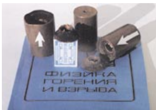
Рис. 1. Характерное разрушение металлической оболочки заряда. Направление детонации показано стрелкой. На заднем плане для сравнения помещена целая оболочка
